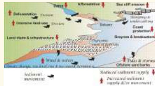
Algumas das principais causas de alteração do transporte sedimentar no interior do "sistema sedimentar". Neste diagrama a costa é constituída por arribas, dunas, zonas húmidas (salinas) de maré e baixios lodosos e arenosos. As águas marítimas costeiras (a azul) e o interior (a verde) constituem o "sistema sedimentar". No diagrama o movimento sedimentar tende a deslocar-se para zonas profundas associadas a certas formações costeiras, tais como um estuário.
