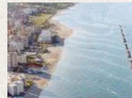
Câmara Municipal de Lido Adriano – Departamento Geológico (Ravenna). Nesta fotografia, é possível observar a localização de edifícios sobre a praia e a consequente necessidade de obras de defesa costeira (neste caso, um campo de quebramares destacados).
